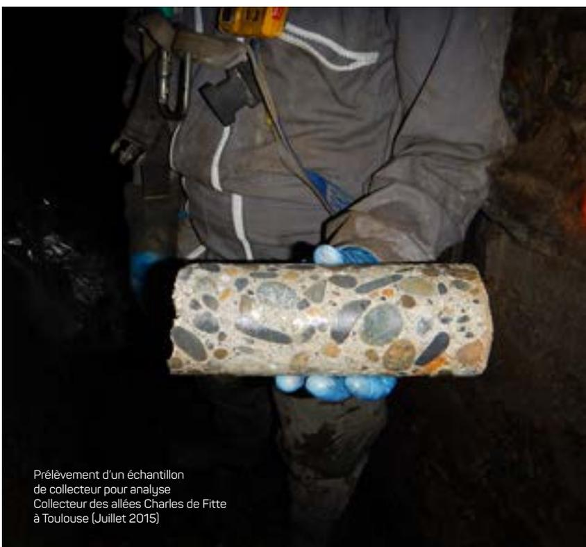
Prélèvement d'un échantillon de collecteur pour analyse
